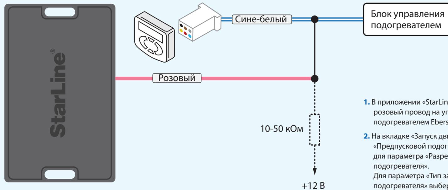
1. В приложении «StarLine Мастер» запрограммируйте розовый провод на управление предпусковым подогревателем Eberspächer по цифровой шине.
