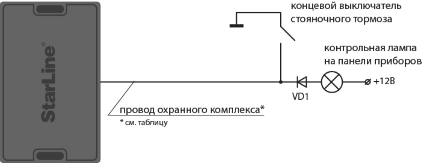
Схема подключения стояночного тормоза
