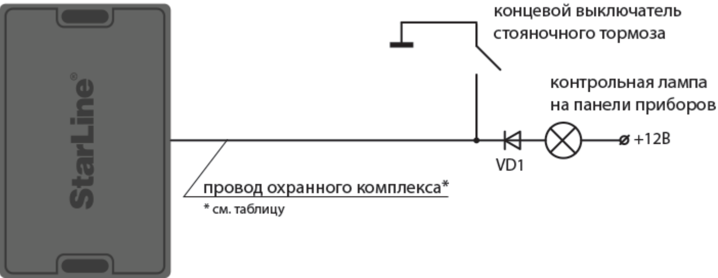
Схема подключения стояночного тормоза
