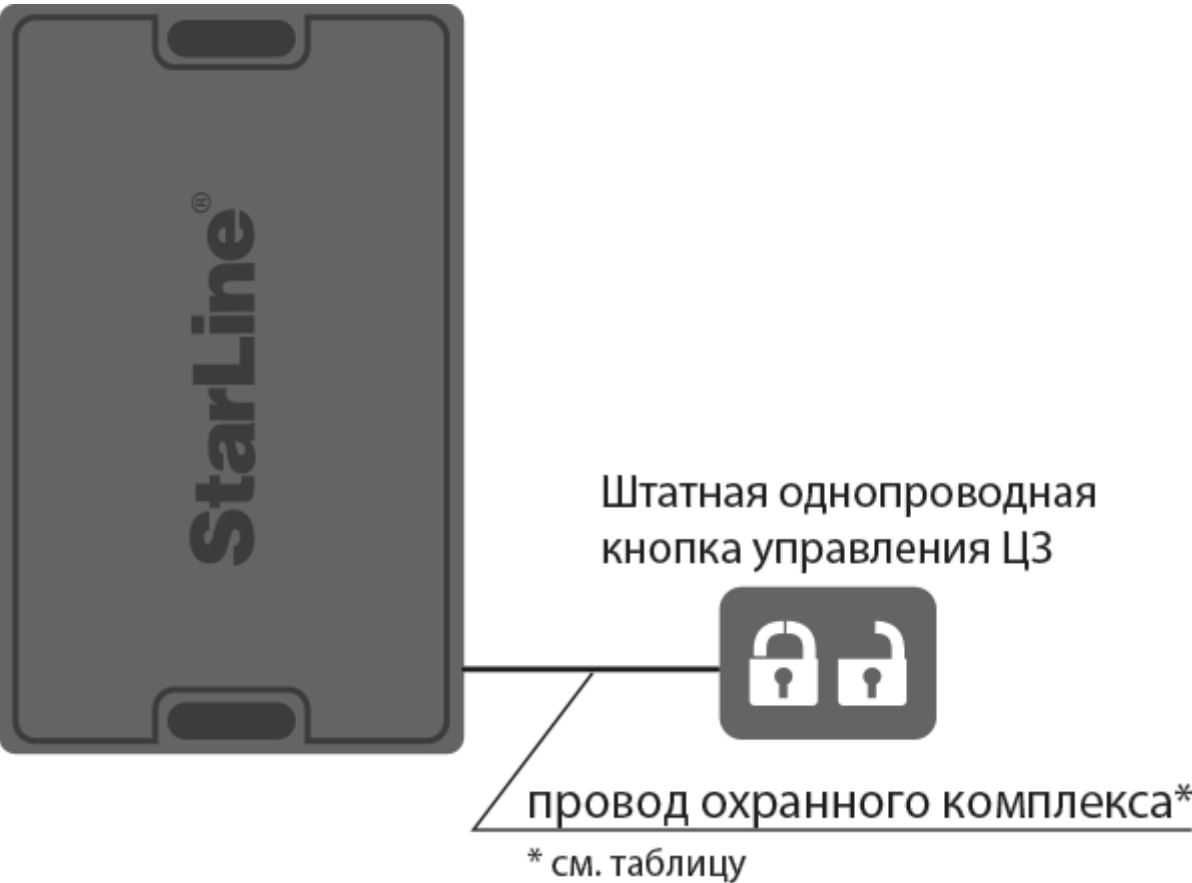
Схема альтернативного подключения системы центрального запирания
