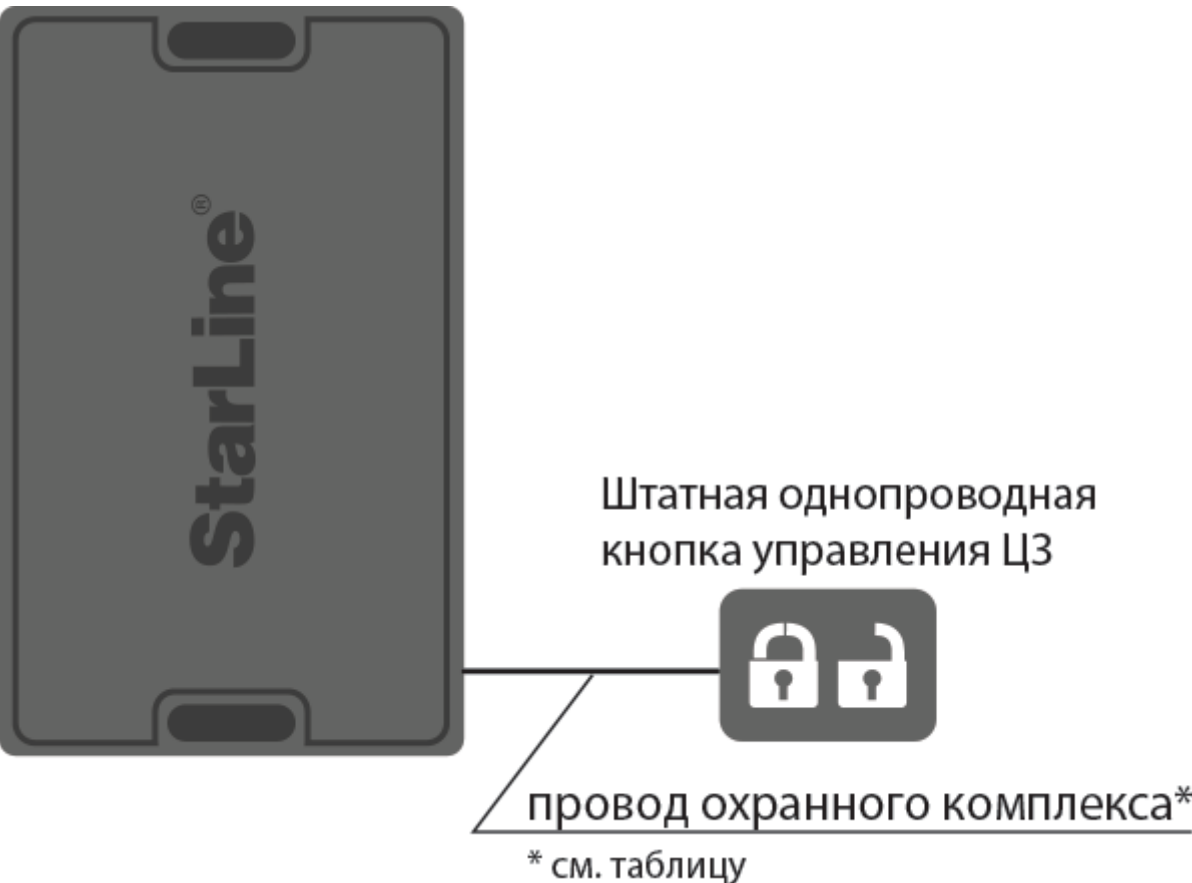
Схема альтернативного подключения системы центрального запирания
