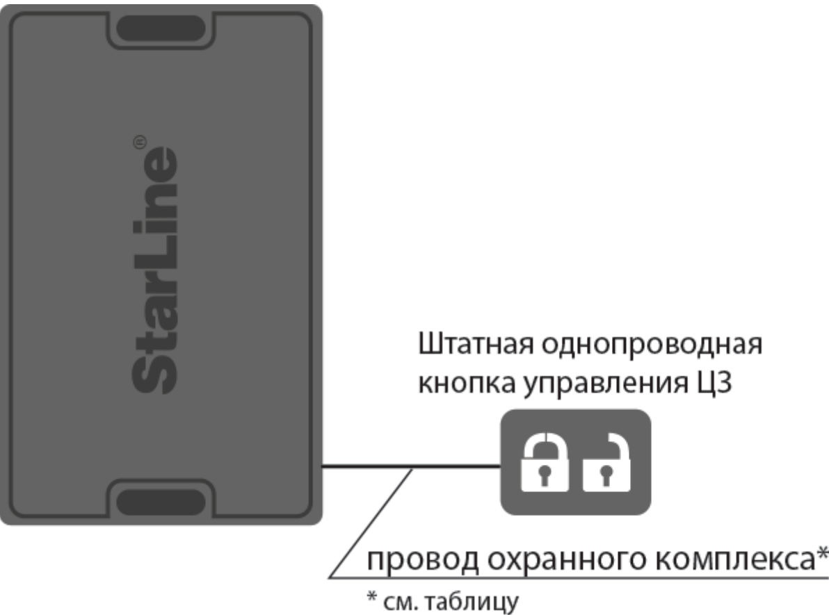
Схема альтернативного подключения системы центрального запирания
