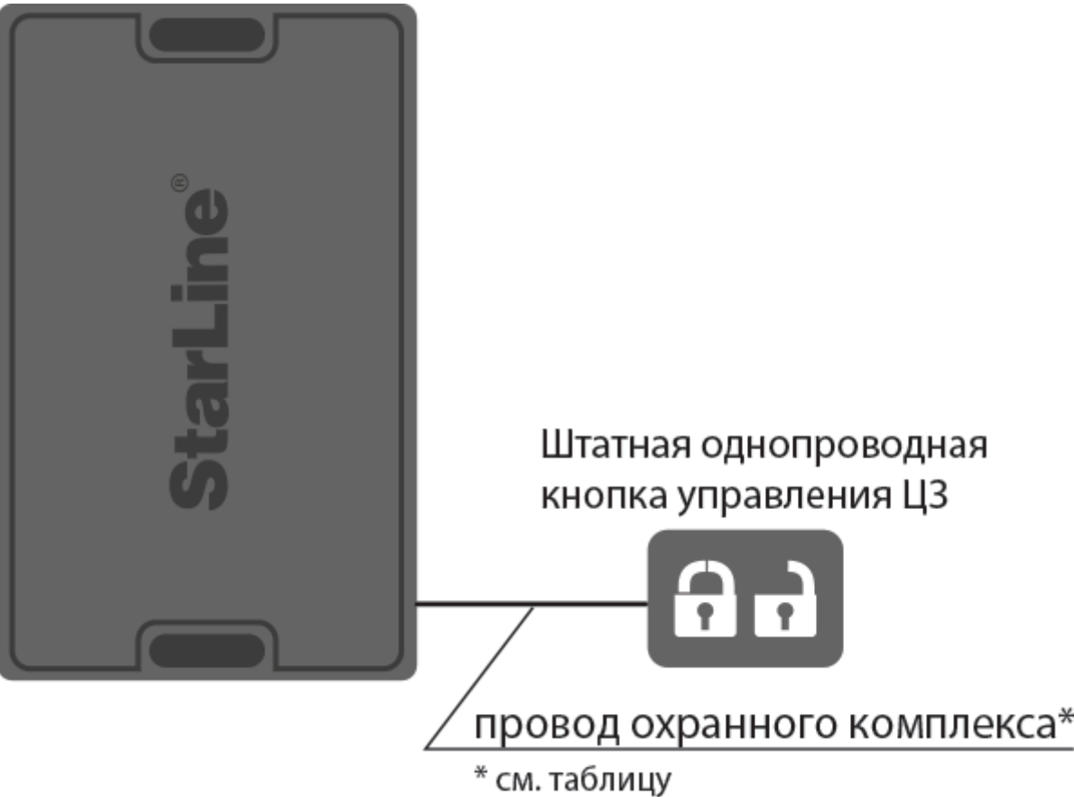
Схема альтернативного подключения системы центрального запирания
