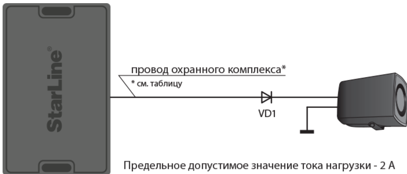
Схема подключения автомобильной сирены
