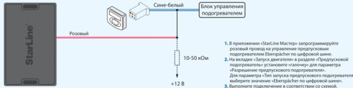
1. В приложении «StarLine Мастер» запрограммируйте розовый провод на управление предпусковым подогревателем Eberspächer по цифровой шине.
