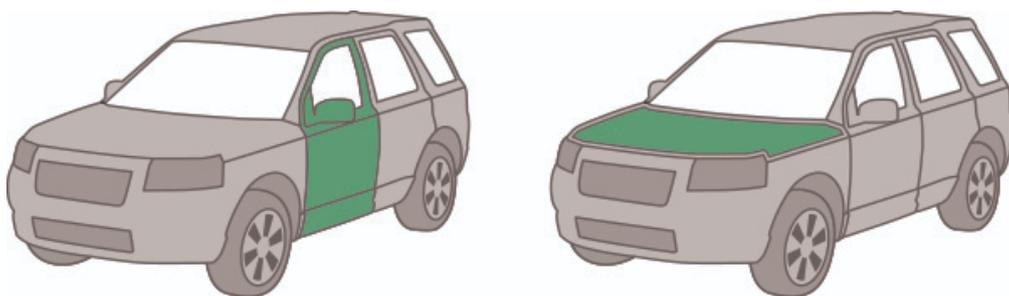
Иммобилайзер имеет выходы для управления центральным замком дверей или замком капота. Использование режима «Свободные руки» позволяет дистанционно управлять центральным замком дверей при приближении и отдалении метки от автомобиля. Более подробное описание см. в разделе [«Управление замком дверей»](#) [Инструкции по эксплуатации](#).
