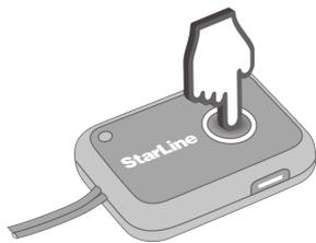
2. Последуют желтые вспышки, сопровождающиеся звуковыми сигналами. Отсчитайте количество вспышек, равное **первой цифре сервисного кода** и коротко нажмите кнопку модуля индикации. Ввод первой цифры завершен.
