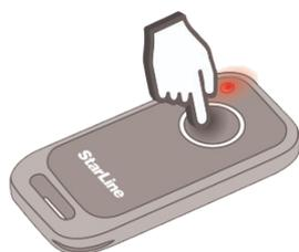
4. Успешная установка низкого уровня чувствительности датчика начала движения будет подтверждена тремя звуковыми сигналами.
