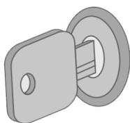
3. **Включите зажигание** - последует серия звуковых сигналов. Отсчитайте количество сигналов, равное **первой цифре сервисного кода** и выключите зажигание.
