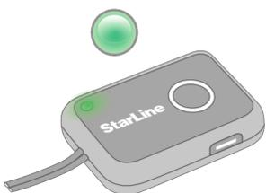
Если сервисный код **введен неправильно**, прозвучат 2 коротких сигнала. Если код будет неправильно введен 5 раз в течение 30 минут, то повторная процедура ввода будет заблокирована на 15 минут. Запрет на ввод кода снимается при появлении метки.
