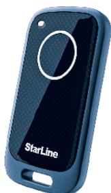
Метки, входящие в комплект поставки, изначально находятся в транспортном режиме, в котором они **отключены!** Нажатие кнопки метки в этом режиме будет индицироваться желтой и красной вспышками встроенного светодиода.
