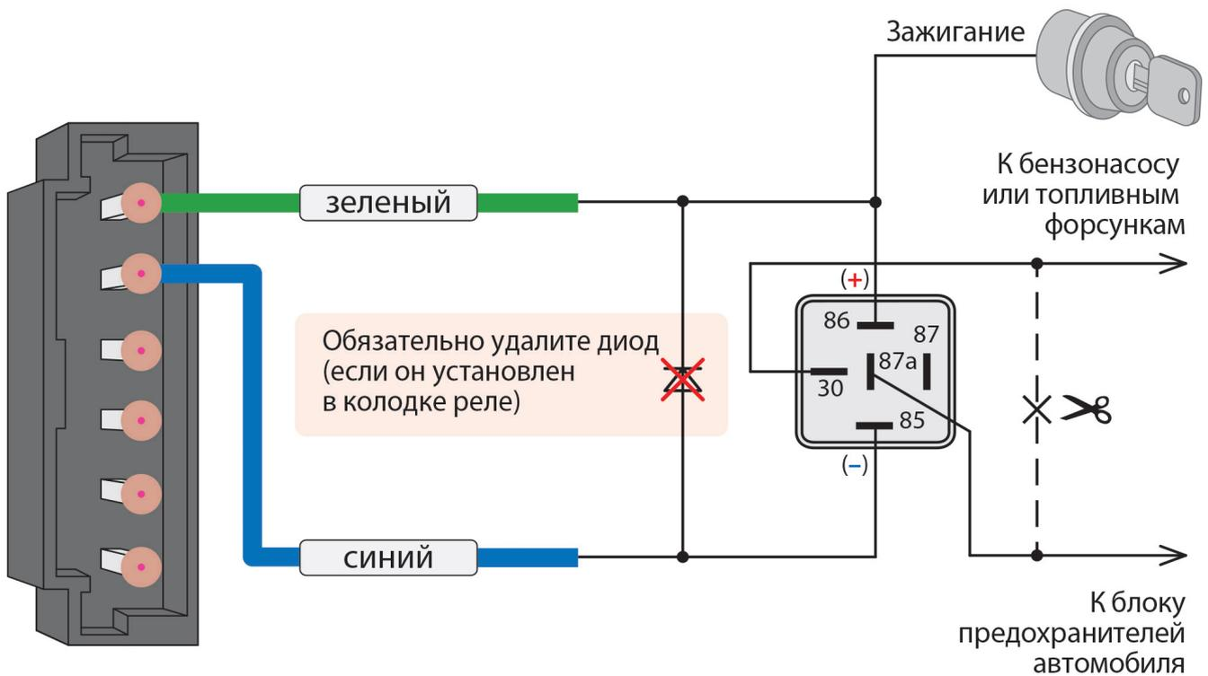
**Зеленый провод** — подключение к цепи зажигания автомобиля.
