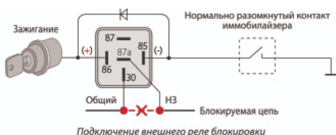
Пример использования НР контактов для блокировки
