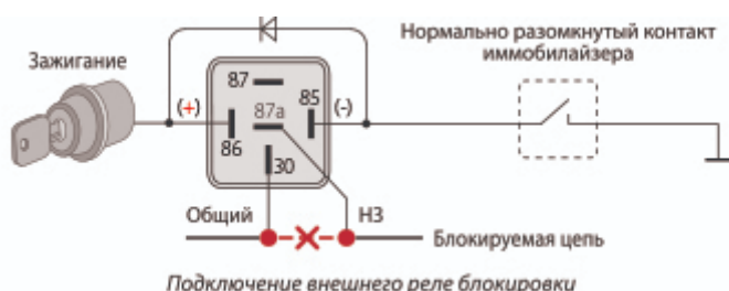
Пример использования НР контактов для блокировки
