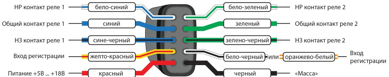
При параллельном соединении двух контактных групп обоих реле максимально допустимый ток будет не более 1А.
