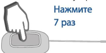
4. Включите зажигание. Последуют 7 вспышек светодиода трансивера и 7 звуковых сигналов.
