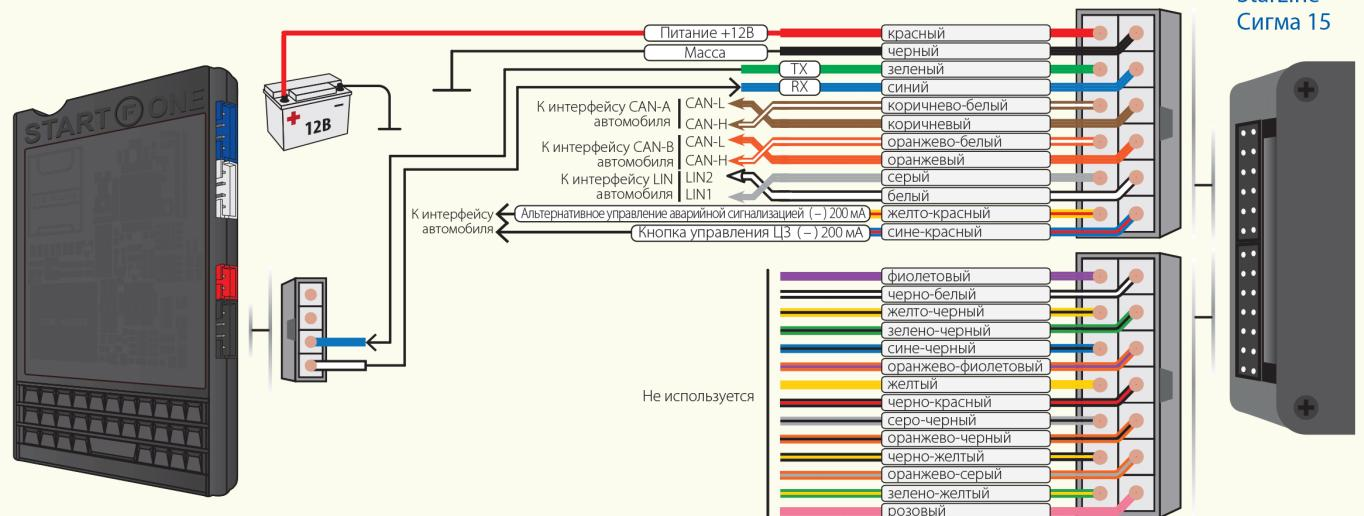
Назначение каналов модуля указано установленным по умолчанию
