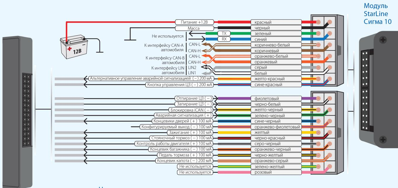
Назначение каналов модуля указано установленным по умолчанию
