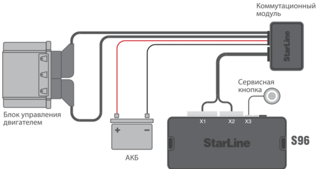
3. Нажмите сервисную кнопку 14 раз и дождитесь подтверждающего двойного светового сигнала на сервисной кнопке.
