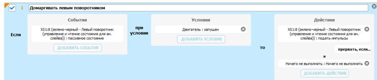
**Событием** для срабатывания программы является переход из активного в пассивное состояние на канале, который мы выбрали для управления поворотником, то есть выключение подрулевого переключателя.
