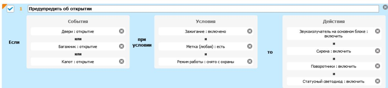
В этом примере охранный комплекс X96 предупредит владельца автомобиля об открытии двери, капота или багажника, если у снятого с охраны автомобиля включено зажигание и любая метка находится в зоне приема. Чтобы владелец обратил внимание на событие, охранный комплекс одновременно включит звуковой излучатель в основном блоке, сирену, поворотники и светодиод индикации.
