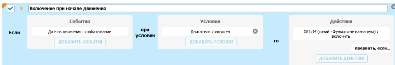
Действие программы — включение аналогового выхода к которому подключено питание прибора. А чтобы регистратор выключался, используем событие остановки двигателя для прерывания программы:
