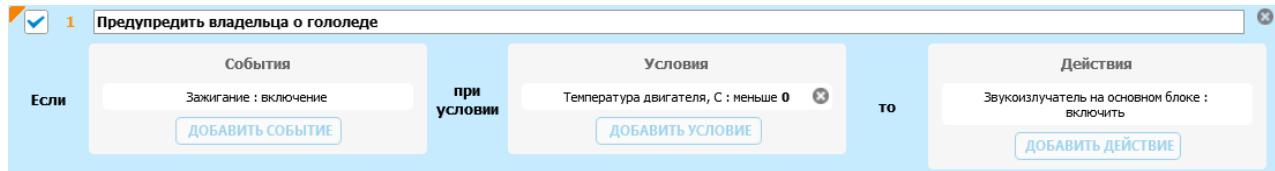
Если при включении зажигания температура двигателя (а значит, и температура воздуха) ниже 0°C, то встроенный в X96 звуковой излучатель выдаст предупреждающий сигнал.
